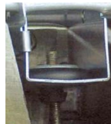
Muestra bajo carga de 300 kg.
